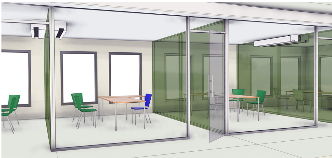
Bild 52. Plafond XD monterad rygg mot rygg runt löstagbar mellanvägg, dikt mot taket.
