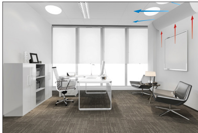
Bild 46. Plafond XD-FC med design Badge. Installationsprincip taknisch.
