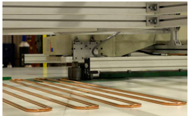
Bild 2: Atrium Planas högprecisionslasersvetsning.
