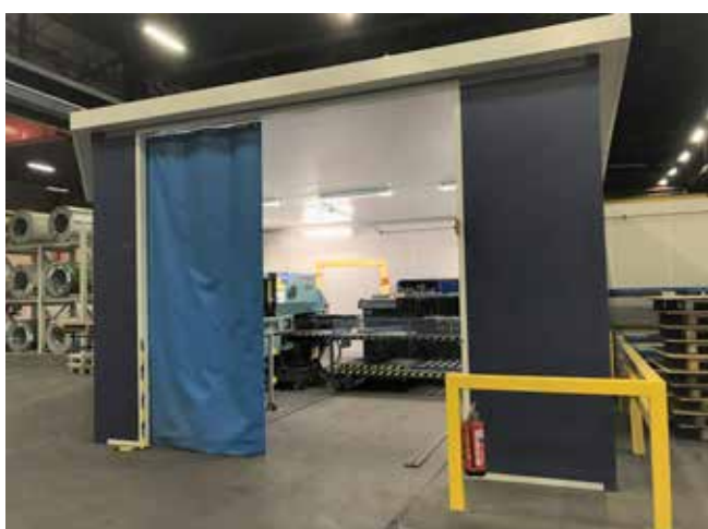
Inbyggnad av bullrande maskin med akustikpanel i väggar och tak
