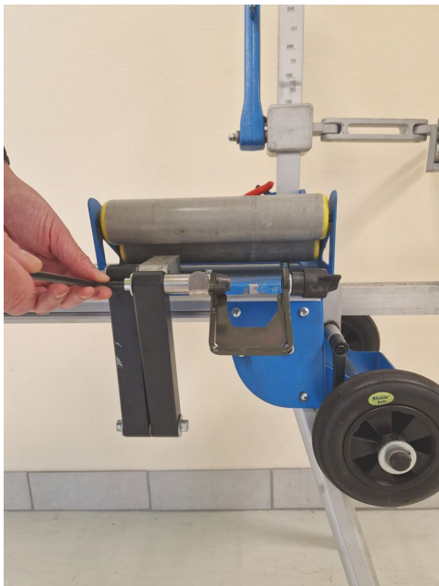
3. Fäst CSAD med låsbulten.
