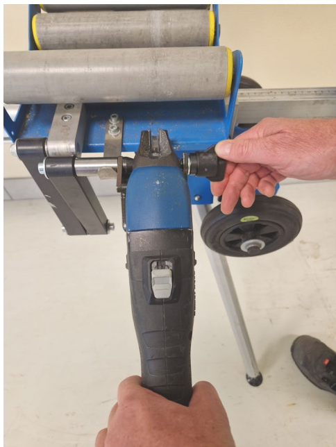
5. Fixera plåtsaxen genom att dra åt låsratten.
