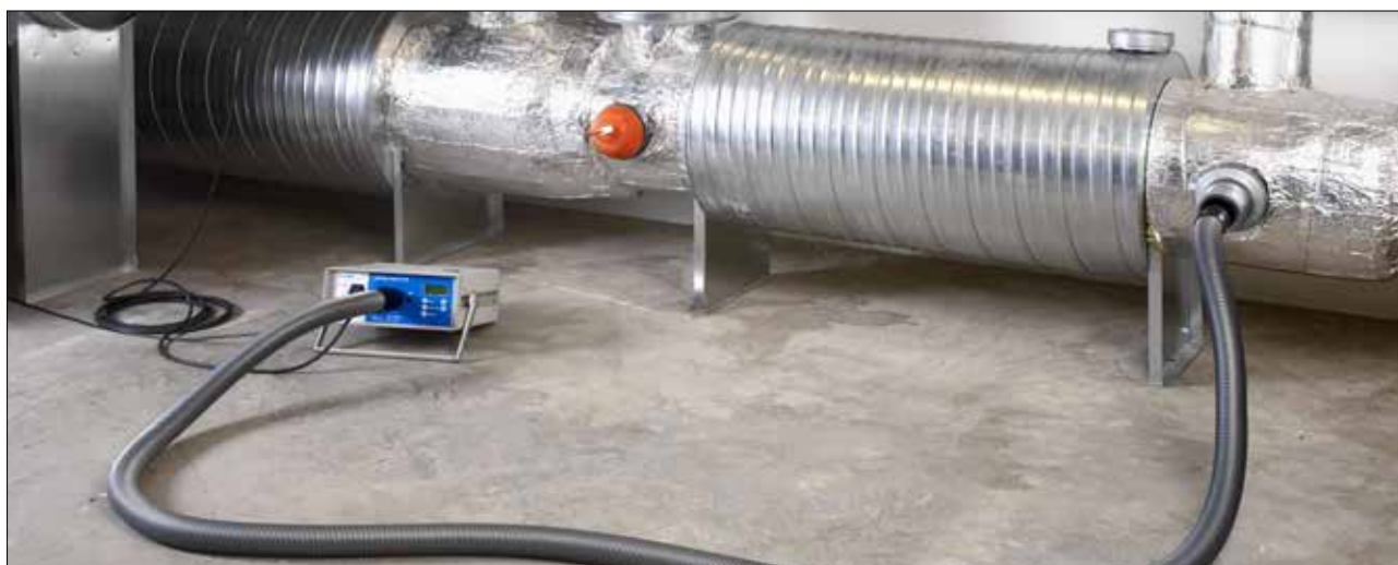
Figure 3 : Raccordement au système de conduits d'air
