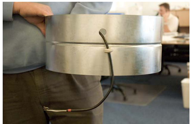
Kabelgenomföring monteras på elkabel.
