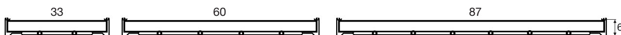
Figur 5. Atrium och Loggia, tillverkas som standard i tre bredder 33, 60*, 87 cm och en höjd 6 cm.
