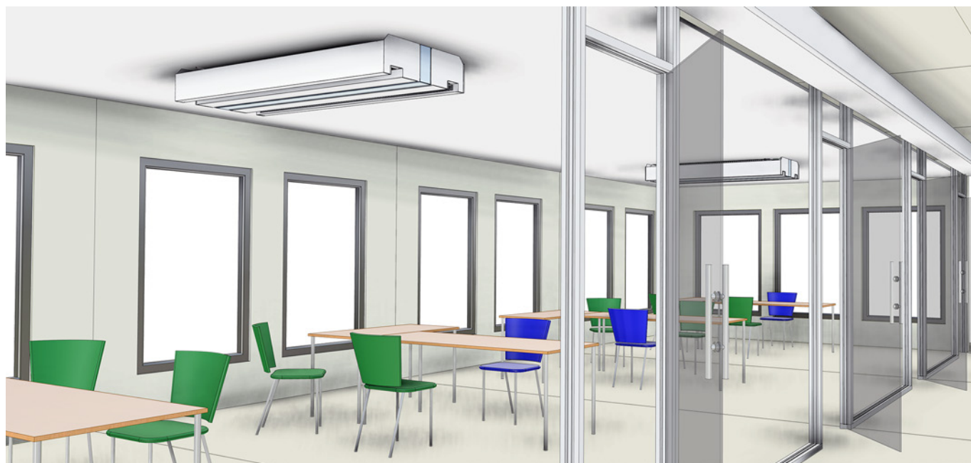
Bild 53. Skiljeväggarna har ersatts med passbit utan att Plafond-installationerna påverkas.
