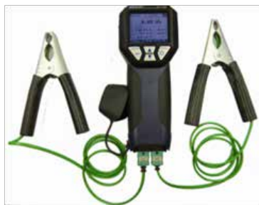
Fig.4: Anslutning av temperaturmätningstångar
