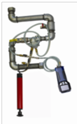
Fig. 54: Volymmätning med PC 410 och en spruta (rörvolym på upp till 100 ml).
