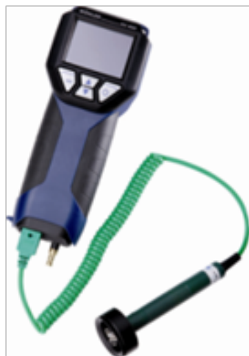
Fig.5: Anslutning av en särskild yttemperatursond för mätning av värmegenomgångskoefficienten.
