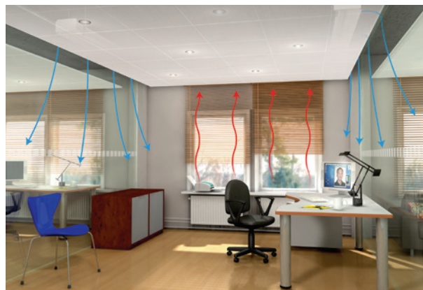
Bild 2.. Celos tekniska lösning bygger på en unik patentsökt teknik som innebär att den kylda luften förs ner genom en utloppsspalt i undertaket längs hela väggen och sedan vidare ner mot golvet.
