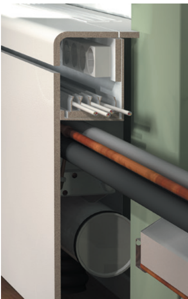
Bild 5. Inklädnad där bänkskivan har en lucka som lyftes uppåt för åtkomlighet.
