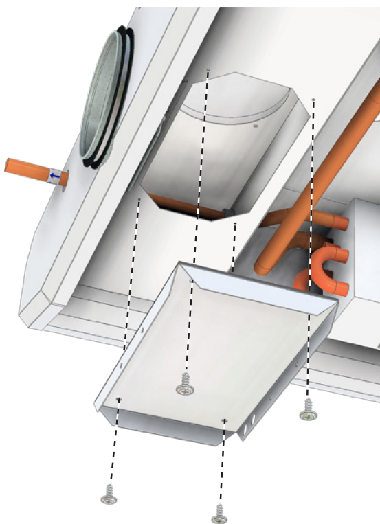
Bild 20. Demontering av rensluckan på luftfördelningslådan.
