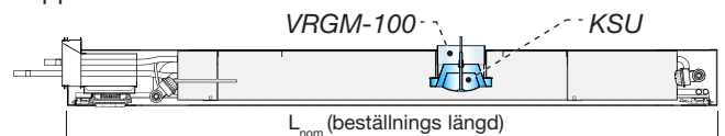
Bild 5. Sektionsbild av I-60 med inbyggd KSU frånluftsventil och VRGM-koppling. OBS! Lösningen kräver ca. 200 mm i fritt utrymme ovanför baffeln.
